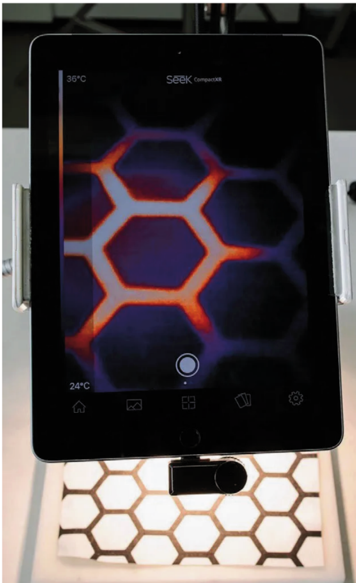
Un termogramma del circuito termico planare in azione
